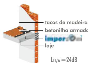
Revestimento a tacos de madeira
