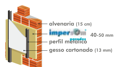
Parede dupla alvenaria/gesso cartonado
